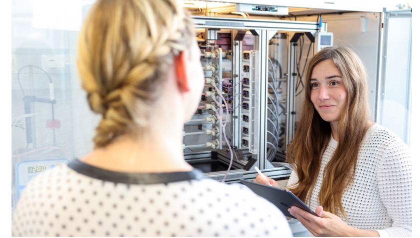
Multiaxialer Ermüdungsprüfstand zur Charakterisierung der Isolation von Herzschrittmachersonden oder peripheren Stents, eine Eigenentwicklung des IIB e.V. mit internationaler Akzeptanz
