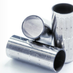
Prozessschritte bei der Herstellung von Stentstrukturen mittels Femtosekunden-Laserschneider – vom Schneiden der Rohrhalbzuge über die mechanische Nachbearbeitung bis zur Formgebung durch Wärmebehandlung
